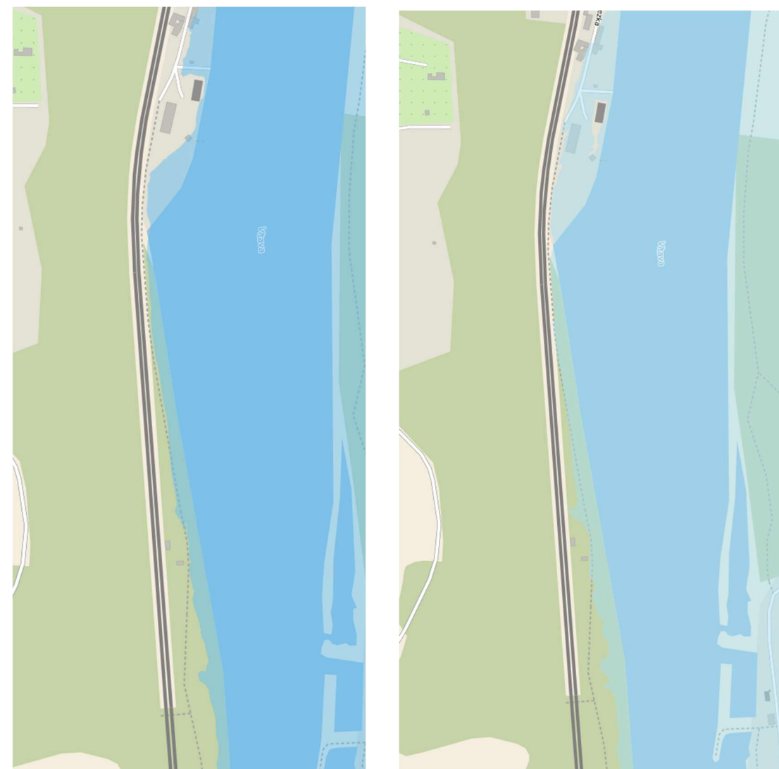
Obr.: Povodňové mapy - Q20, Q100
