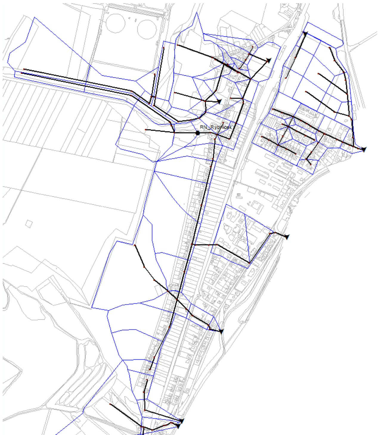
Obr. 4.2 - Simulační model MIKE Urban. Část Hledsebe a Podhořaby.
