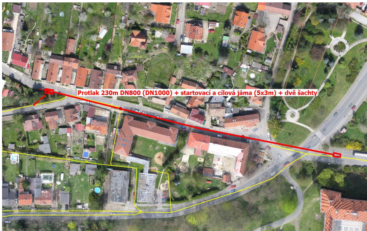
Obr. 7-26 Varianta IV – protlak DK 1000 pod ulicí Školní
